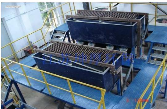
四川煤化工废水电絮凝处理装置组
