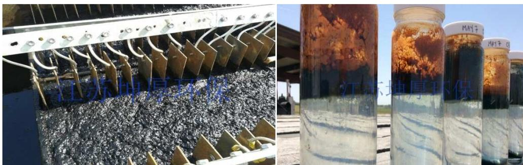
电絮凝设备的电极板可根据去除物质的不同而选用不同的材料，产生强絮凝、强氧化、强还原、强气浮等作用，以达到最佳处理效果，经常应用的有铁、铝、钛、石墨、二氧化铅等。每种材料都有其适于应用的领域，电絮凝设备的设计和电极板的选择是经过大量的研发试验和丰富的工程实践经验而确定的。根据大量的试验验证电絮凝设备对于废水中的各类杂质物质去除效果如下：
